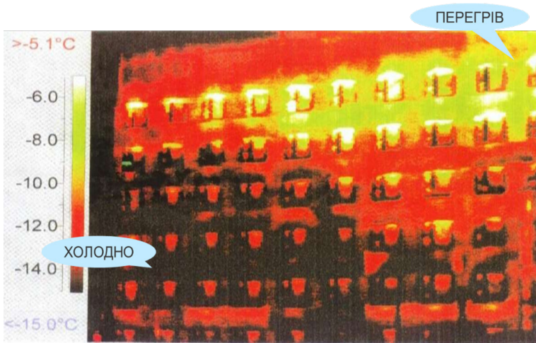
Рис 10. Розбалансована система опалення (Danfoss)
